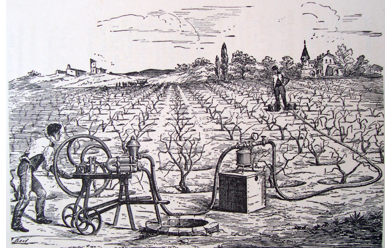
FIG. 34. — Petit appareil Fafeur frères, fonctionnant avec une pompe à bras, dans les vignobles du Midi.
